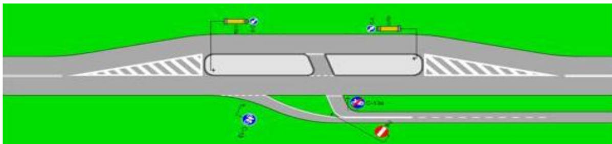
Rysunek 18. Włączenie dwukierunkowej drogi dla rowerów do drogi ogólnodostępnej przy zastosowaniu azyłu
