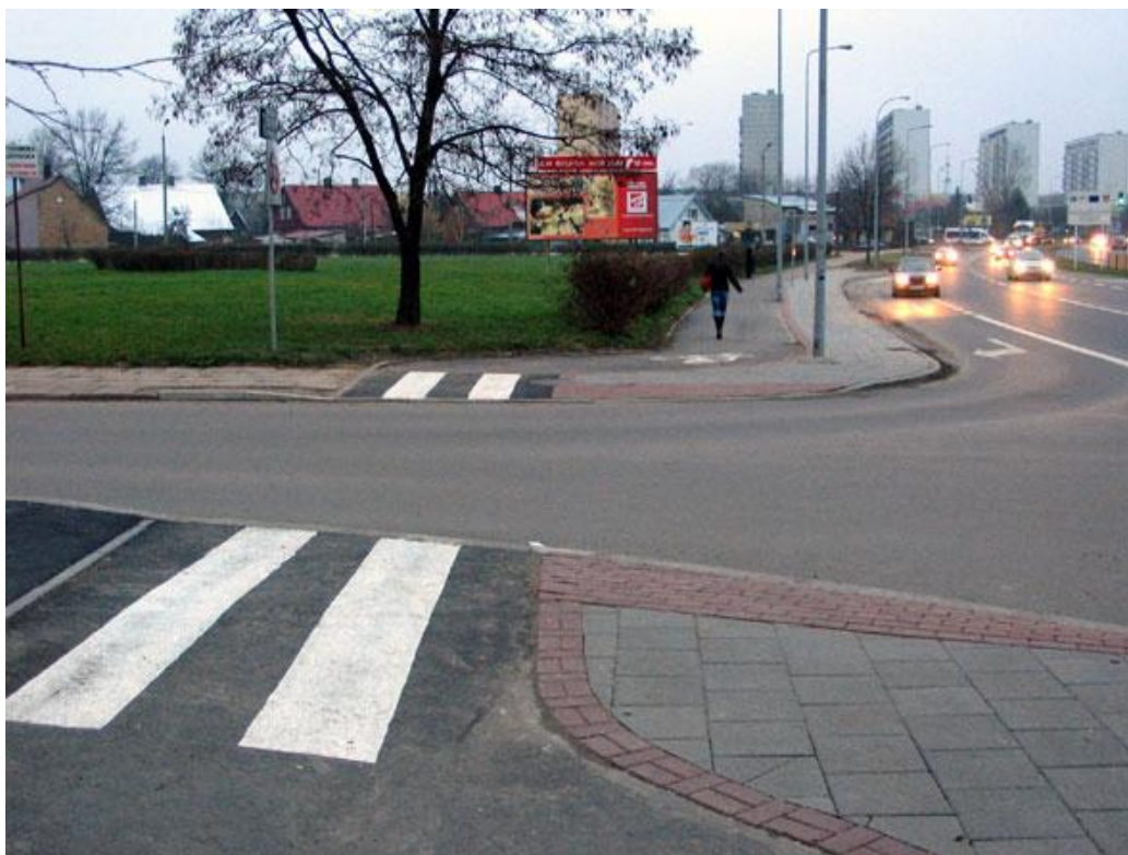
Ilustracja 23. Nieprawidłowe odgięcie trasy rowerowej na skrzyżowaniu
