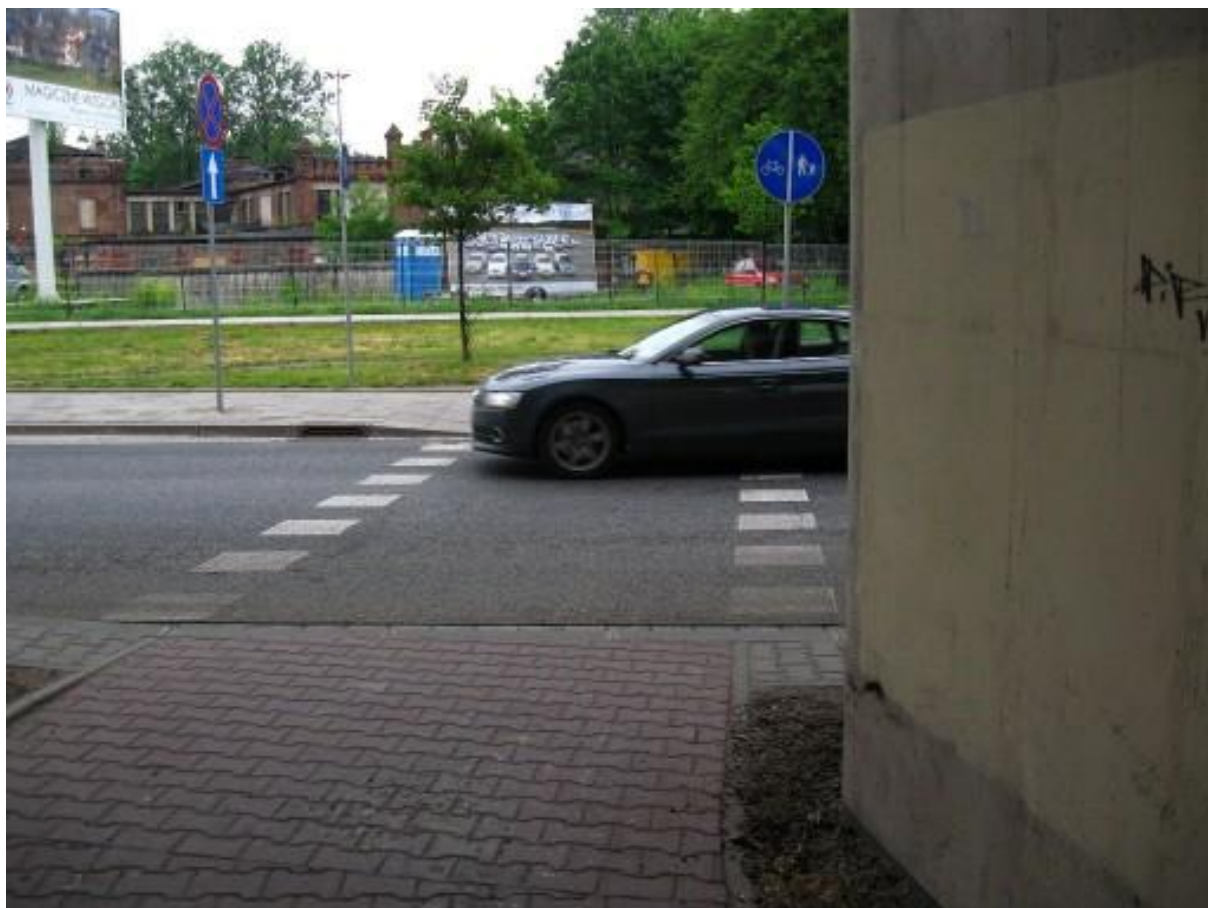
Ilustracja 22. Brak widoczności przed przejazdem dla rowerzystów – konieczny znak B-20 „stop”
