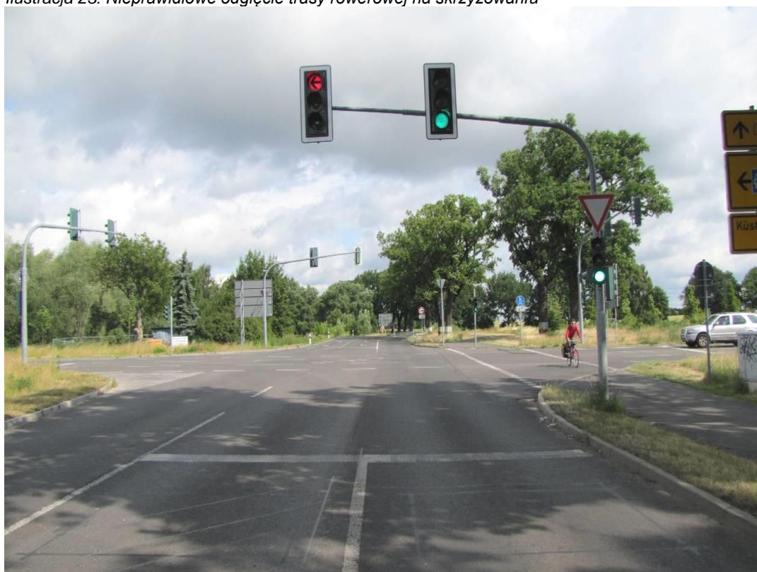
Ilustracja 24. Prawidłowe przeprowadzenie trasy rowerowej przez skrzyżowanie
