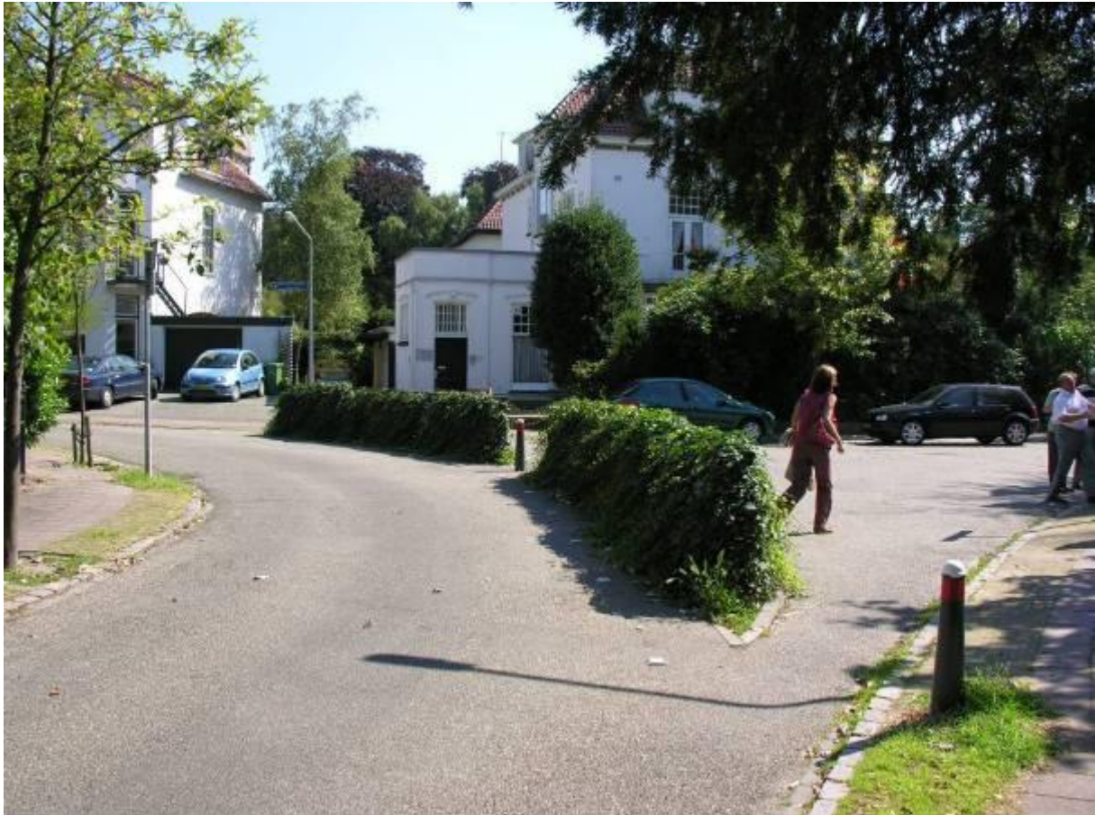
Ilustracja 8. Jedna z form rozcięcia skrzyżowania uniemożliwiającego przejazd samochodem a umożliwiającego przejazd rowerem
