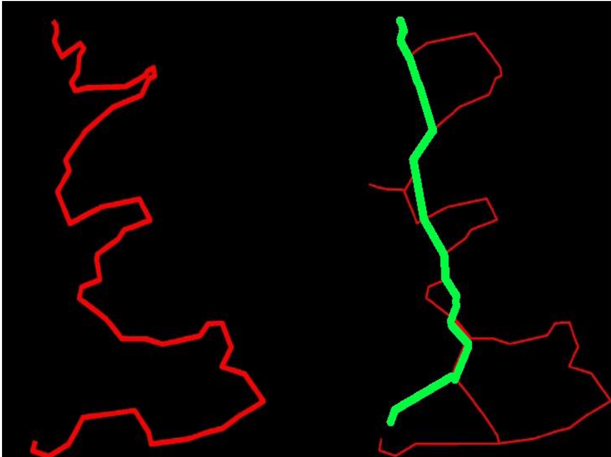
Rysunek 2. Po prawej stronie prawidłowo, po lewej błędnie zaprojektowana główna trasa rowerowa
